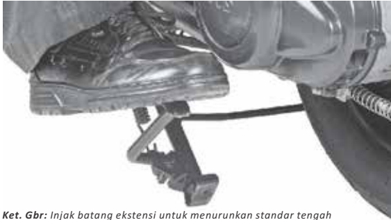
Ket. Gbr: Injak batang ekstensi untuk menurunkan standar tengah
