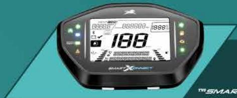
Speedometer Digital dilengkapi dengan fitur Smart Connect. Teknologi yang menghubungkan Smart Phone dengan motor Anda melalui koneksi Bluetooth
